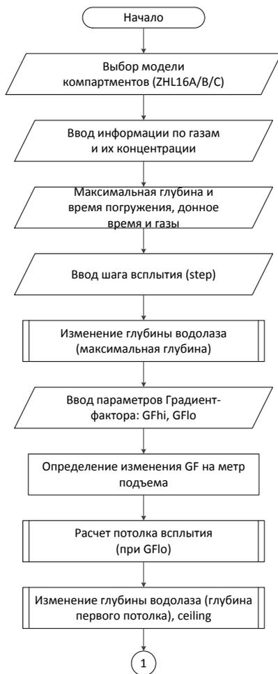
Рис. 3. Первая часть блок-схемы алгоритма построения плана погружения
